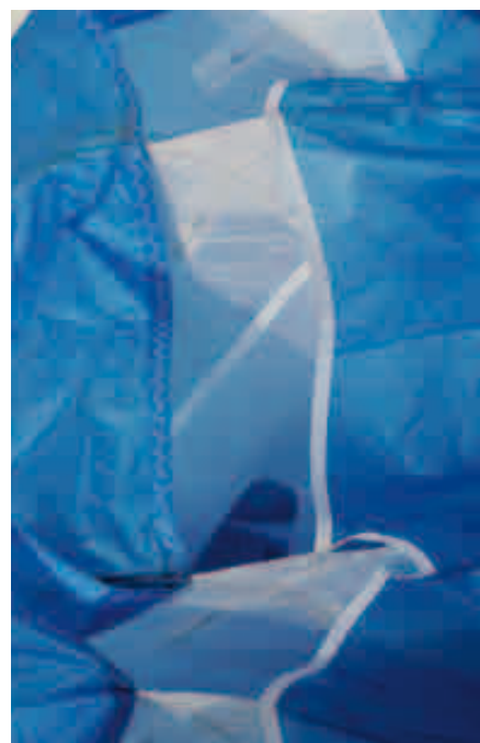
Les joncs en Nitinol, hérités des ailes de compétition de la marque. Matériau souple et léger « à mémoire de forme », ils sont bien sûr insérés dans de solides fourreaux.
