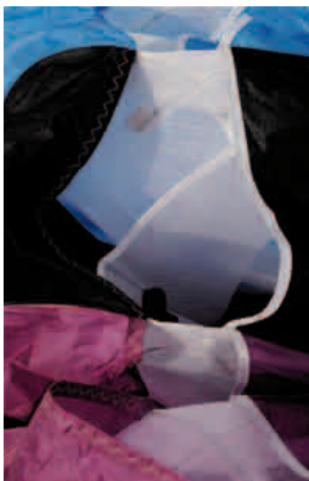
Les joncs en Nitinol, hérités des ailes de compétition de la marque. Matériau souple et léger « à mémoire de forme », ils sont bien sûr insérés dans de solides fourreaux.
