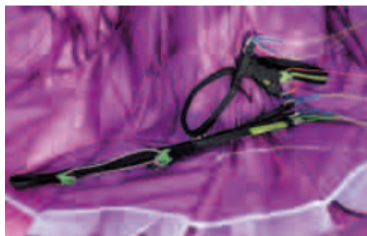
Suspentes Aramide en bas, Dyneema en haut. Des élévateurs fonctionnels irréprochables, notez les poulies et la poignée de pilotage sur les C.
