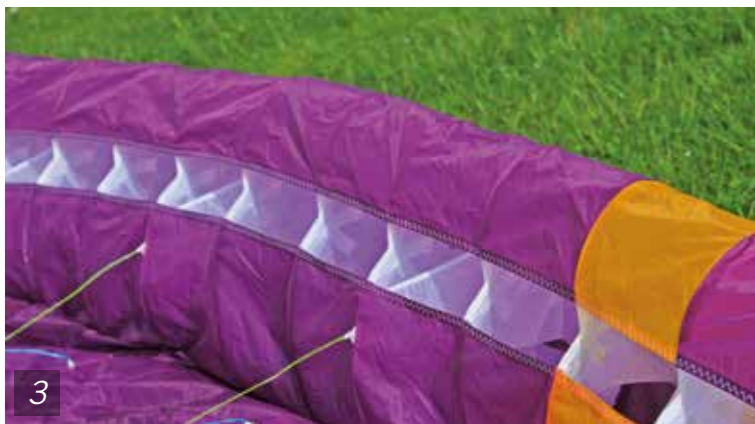
1. Relativ weit hinten am Obersegel sieht man die Quernähte des 3D-Shaping. 2. Sehr saubere Verarbeitung der Nähte.
