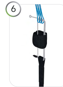
6 Schiebe das Ende der Schlaufe zunächst nach oben durch die elastische Hülse (nicht mehr durch das Röhrchen) und dann nach demselben Muster durch die Leinen.
