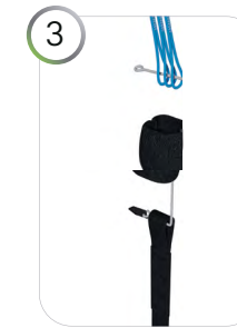
3 Schiebe nun die IKS-Leine durch die Leinen und den Tragegurt. Das verstärkte Ende mit der schwarzen Lasche befindet sich am Tragegurt.
