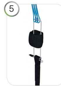
5 Wiederhole dies entgegen dem Uhrzeigersinn, indem du das Schlaufenende durch den Tragegurt schiebst.
