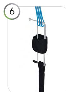
6 Passer à la montée la boucle blanche dans la gaine élastique (non pas dans le petit canal), puis enfin dans les suspentes.
