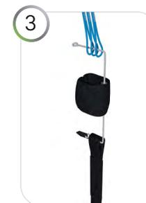
3 Passer la boucle blanche dans les suspentes et la boucle avec la sanglette noire dans l'élévateur.
