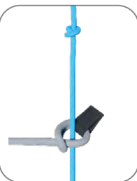
Diagramme 1. Connexion de l'accélérateur avec des crochets Brummel. La ligne bleue est celle de la sellette, et la grise, de l'élévateur.
