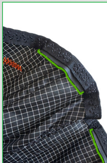
x8 Hypalon-Verstärkung an der Stab-Endnaht
