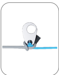
Blind 1. BESCHLEUNIGER- Verbindung mit einem Brummelhaken.
