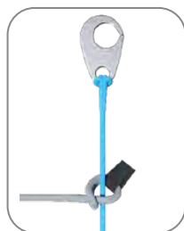
Blind 2. BESCHLEUNIGER- Verbindung mit einem Dracheknoten (ohne Brummelhaken).
