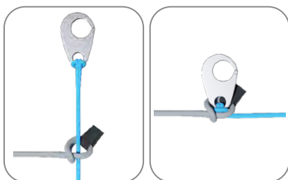
Diagramme 1. Connexion de l'accélérateur avec des crochets Brummel.
