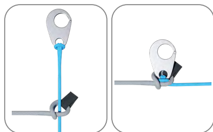
Gráfico 1. Conexión del acelerador mediante el paso del gancho Brummel.
