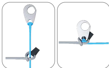
Diagramme 1. Connexion de l'accélérateur avec des crochets Brummel . La ligne bleue est celle de la sellette, et la grise, de l'élévateur.
