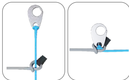
Gráfico 1. Conexión del acelerador mediante el paso del gancho Brummel . El suspente azul es de la silla y el gris, de la banda.
