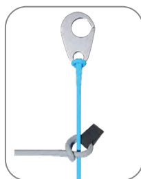
Diagramme 2. Connexion de l'accélérateur avec tête d'alouette (sans crochets Brummel). La ligne bleue est celle de la sellette, et la grise, de l'élévateur.
