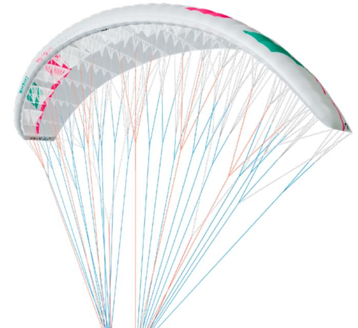
Une parachutale est pratiquement impossible avec cette aile. Si elle entre dans une phase parachutale, l'aile vient se caler sur l'arrière et devient instable, entraînant un manque de pression sur les commandes de frein, bien que le profil semble être entièrement gonflé. Pour retrouver une vitesse air suffisante, relâchez symétriquement la tension des freins et poussez manuellement sur les A, déplacez votre corps SANS VOUS APPUYER SUR LES LIGNES DE FREIN.
