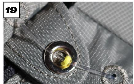
Die Enden der Splinte kannst du in die Löcher stecken. Danach kann die Schnur vorsichtig und langsam aus der Schlaufe entfernt werden.
