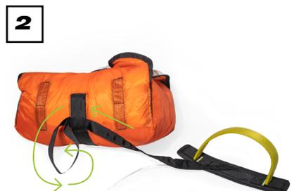
Um den Innencontainer mit dem Rettergriff zu verbinden, muss das Band des Griffes durch die Schlaufe am Innencontainer geführt werden. Anschließend wird der Rettergriff durch die Schlaufe, die sich am Ende des Bandes des Rettergriffes befindet, hindurch gegeben um einen Achterknoten zu machen.
