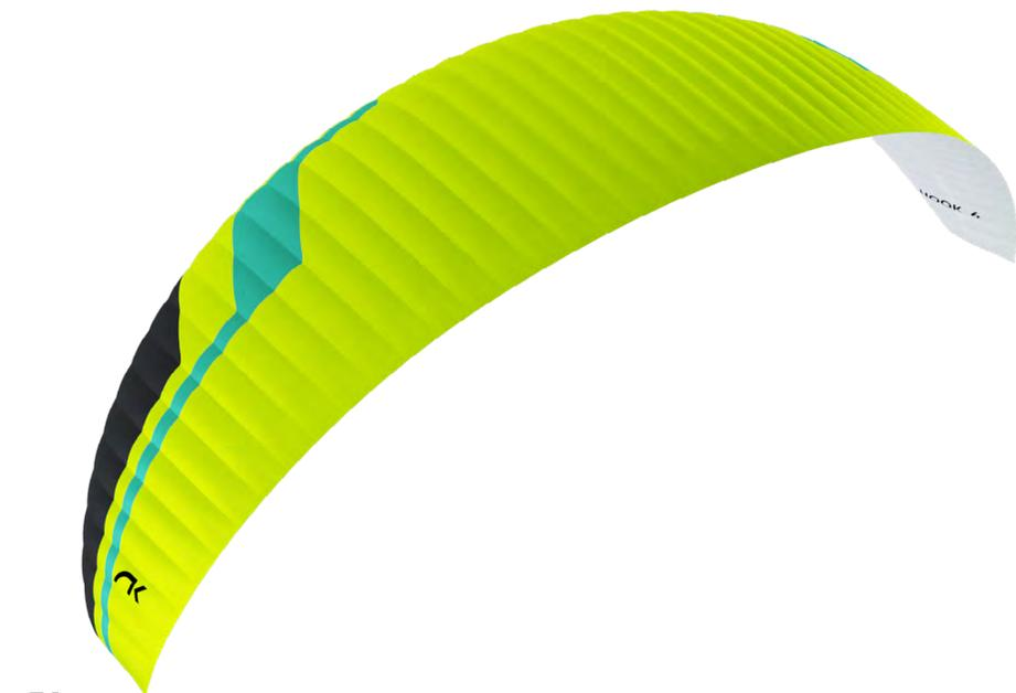
Pour effectuer la manœuvre dite des « grandes oreilles », prenez la suspente A' de chaque élévateur A (ligne 4A3 sur la HOOK 6) et tirez simultanément en douceur vers l'extérieur et vers le bas. Les bouts d'ailes se replient.
