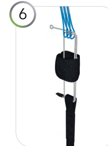
6 Seguir el movimiento y pasar ahora el extremo, de nuevo, por dentro de la funda (no por el canal) y después por la banda.
