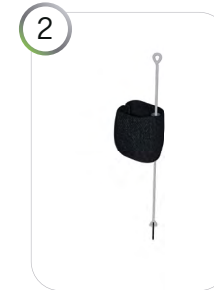
2 Pasar la línea del IKS a través del canal interior. Solo se pasará por el canal interior la primera vez.
