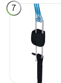
7 Volver a pasarlo por la funda (no por el canal) y después por el loop del extremo reforzado.
